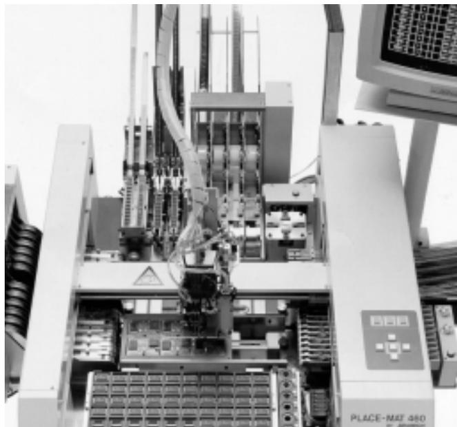
*Robot armado automático de placas de SMD*
